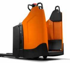
Optional: manuell hochklappbare Plattform, feste Rückenlehne, feste Seitenschutzwände Truck features
